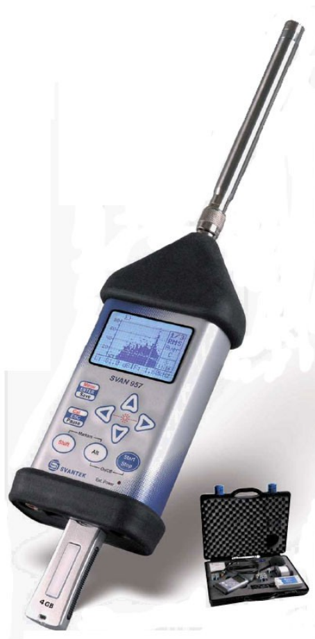
12 pav. SVAN 957 Triukšmo ir vibracijos matuoklis.
